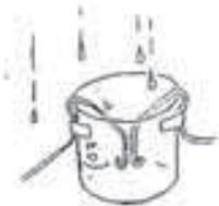
Ce circuit montre un autre élément conducteur de l'électricité... l'eau. Cela ne doit rien avoir de surprenant, car le corps humain, qui est fait essentiellement d'eau, conduit l'électricité.
