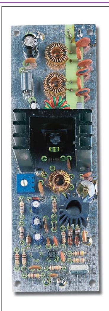
Figure 4 : Photo de l'émetteur vu verticalement. Si vous remplacez la valeur du quartz et si vous modifiez le nombre de spires des bobines, vous pouvez également faire fonctionner ce circuit sur 7 MHz.
